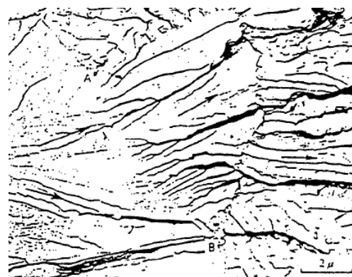
FIG. 4-34.— Patrones tipo “river patterns” característicos de la fractura frágil.
