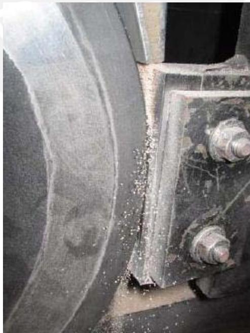
**Figura 2.19 Rueda recubierta en contacto con la probeta sometida al flujo de abrasivo. (Gráfico obtenido de la referencia [22]).**
