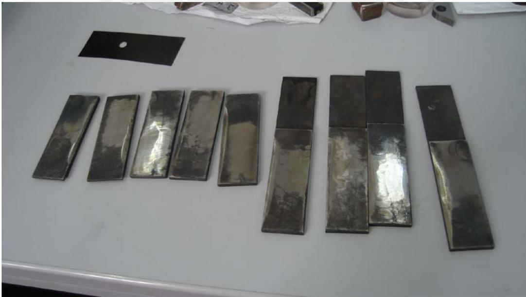
Figura 2.12 Probetas listas para pasar al microscopio óptico.
