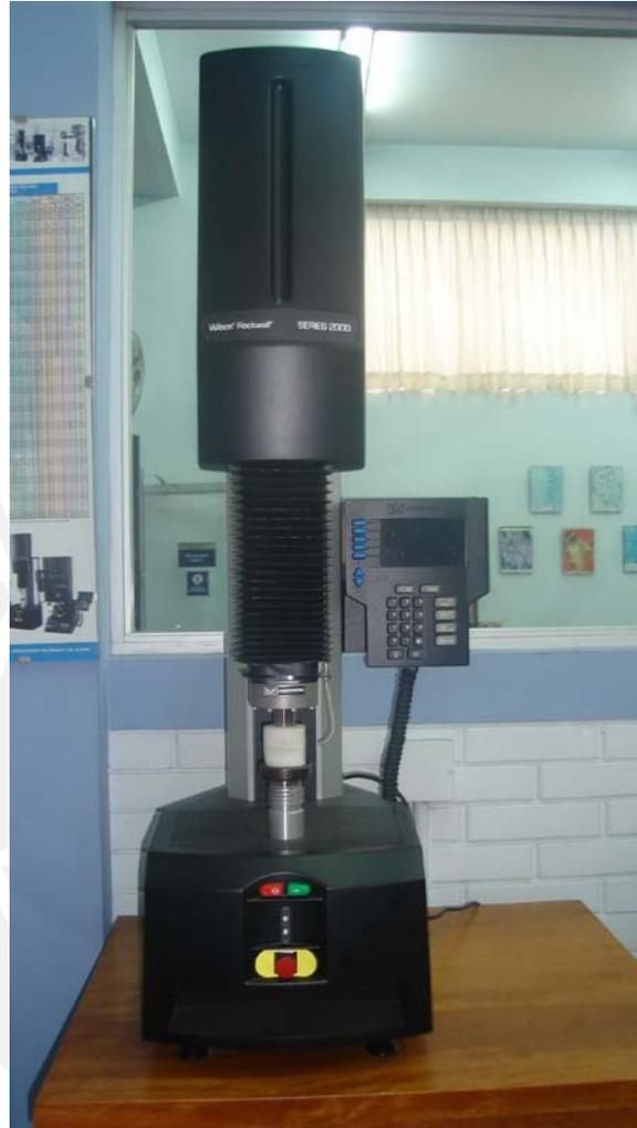
Figura 2.11 Máquina para el Ensayo de Dureza Rockwell C.
