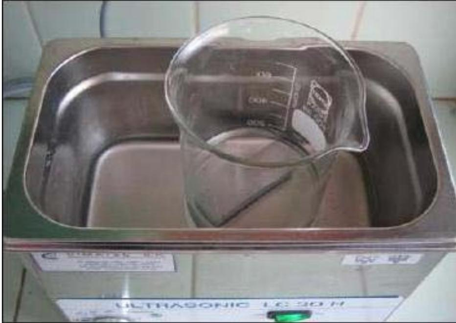
Figura 2.15 Limpieza ultrasónica. (Gráfico obtenido de la referencia [22]).
