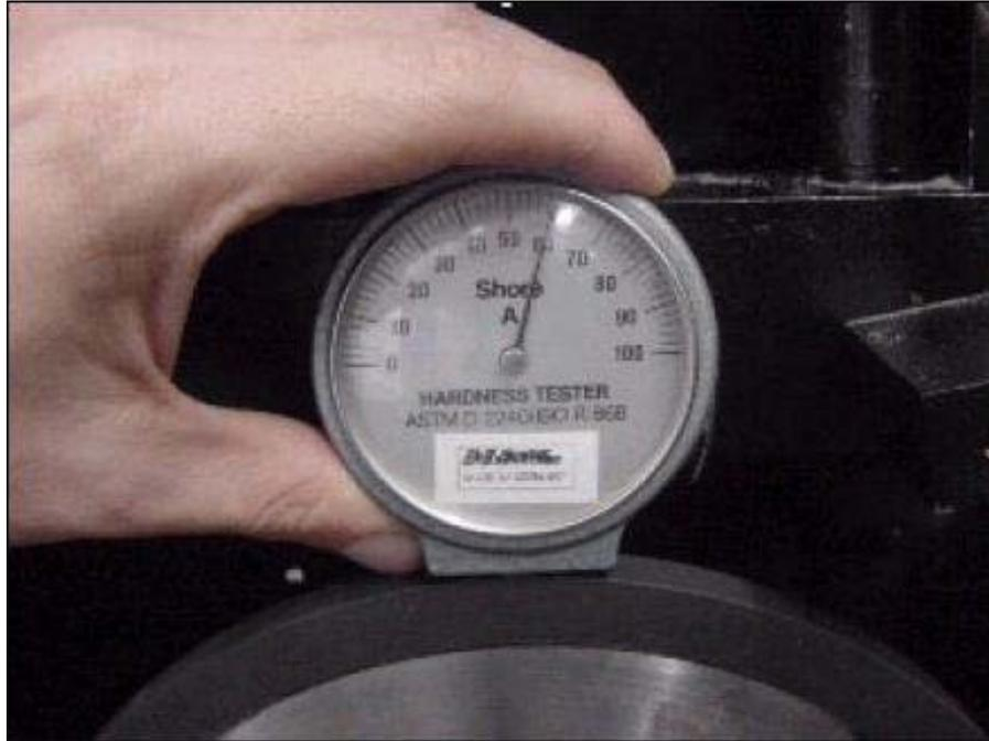
**Figura 2.17 Medida de dureza por el método Shore A.**
