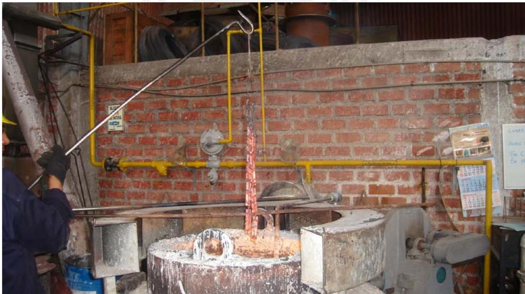
Figura 2.4 Horno de templado a  $940^{\circ}\text{C}$  ó  $980^{\circ}\text{C}$  (según sea el caso).
