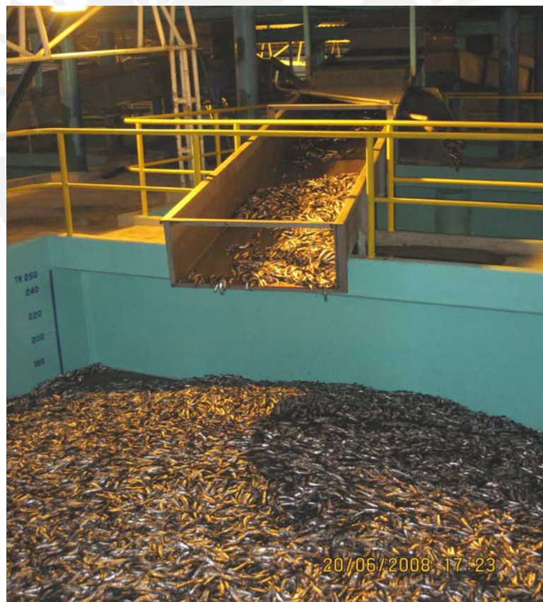
Fig. 3.9. Pantalón Distribuidor a pozas
