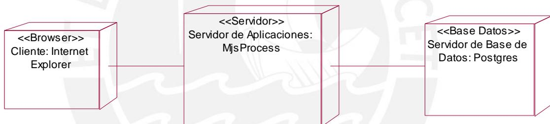
**Ilustración 3-14: Diagrama de Despliegue**
