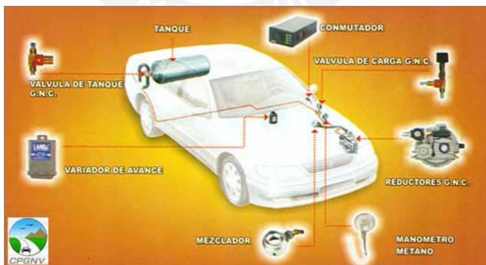
Figura 19: Componentes principales del kit de conversión a gas natural Fuente: Cámara Peruana del Gas Natural Vehicular
