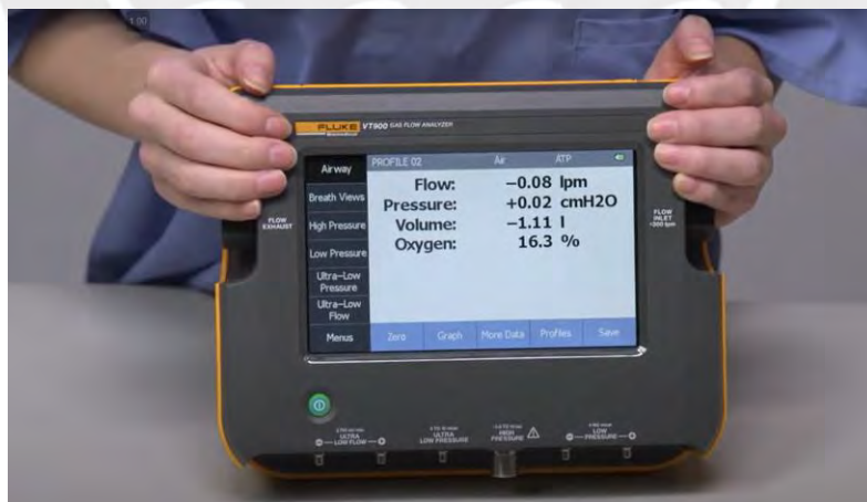
Figura 3.5 Parámetros de vías respiratorias mostrados en la pantalla del analizador [Fluke B., 2017]
