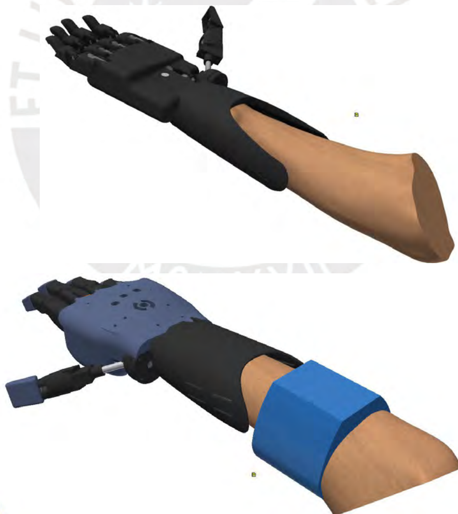
Fig. 5.1. Sup: Prótesis “PUCP-Hand”. Inf: Prótesis con sistema de retroalimentación implementado.
