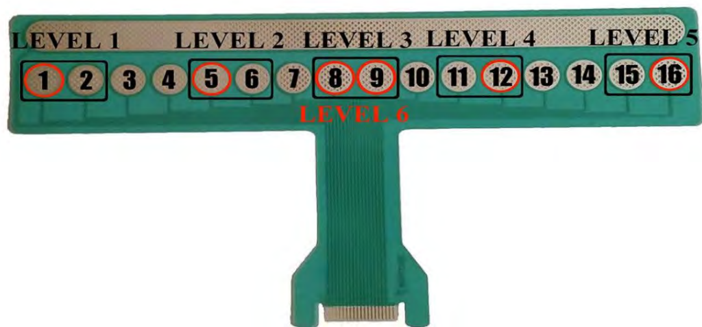
Fig. 1.37. Arreglo de electrodos del sistema Isaković [Isaković, 2016].
