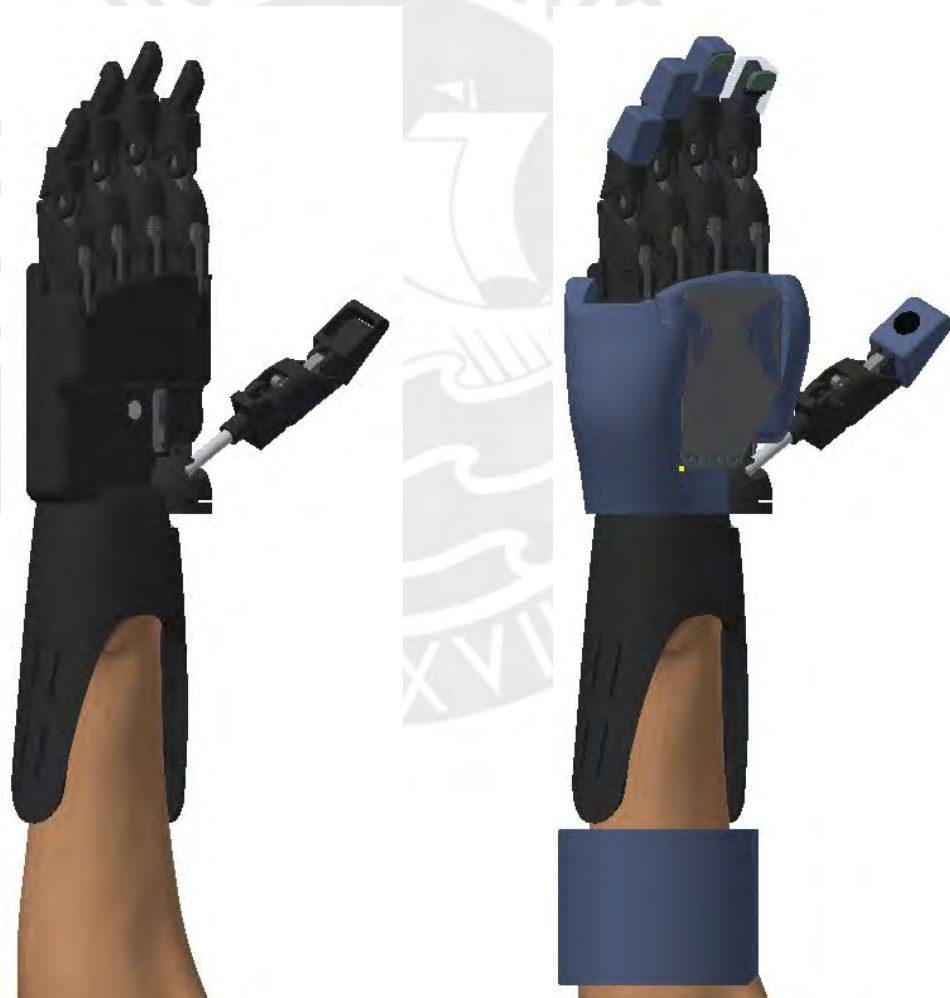
Fig. 3.18 Izq: Prótesis sin sistema de retroalimentación. Der: Prótesis con sistema de retroalimentación
