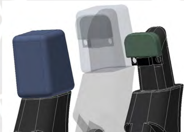
Fig. 3.19 Disposición de los sensores FSR en falanges distales.
