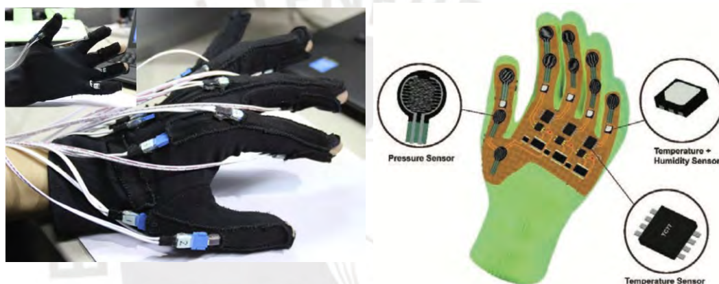
Fig. 1.6. Sistemas sensoriales para detección de presión. Izq: Guante sensorial Zheng [Zheng, 2016], Der: Guante sensorial Polishchuk [Polishchuk, 2016].
