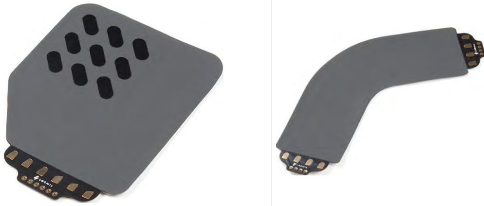
Fig. 3.3 Izq: Sensor de Fuerza ‘Loomia’ ; Der: Cable flexible.
