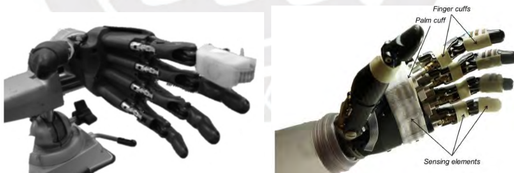
Fig. 1.7. Sistemas sensoriales para detección de deslizamiento. Izq: Aditivo dactilar Osborn [Osborn, 2013], Sistema palmar Osborn [Osborn, 2014].
