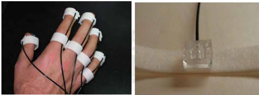
Fig. 1.13 Izq: Guante de transmisión de fuerzas neumáticas sobre cada dedo. Der: Actuador neumático Culjiat [Culjiat, 2010].
