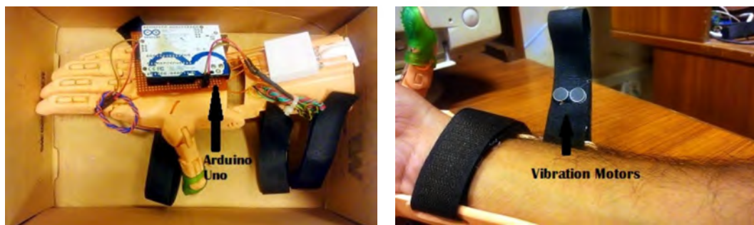
Fig. 1.17 Izq: Prototipo de prótesis Nabeel. Der: 2 motores vibradores sobre antebrazo [Nabeel, 2016].
