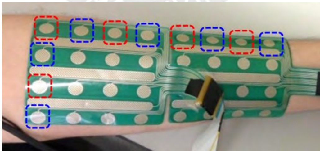
Fig. 1.33. Arreglo tipo matriz sobre antebrazo de usuario [Franceschi, 2017].
