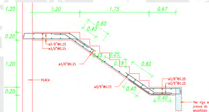
Figura 135. Diseño final del tramo de escalera analizado
