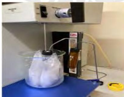
*Nota. La figura muestra cómo debe colocarse los viales en el equipo de extracción por EFS y recibir el extracto a bajas temperaturas para evitar pérdidas del aceite esencial de kion.*
