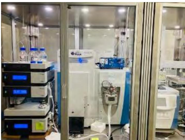
*Nota. La figura muestra el equipo de HPLC que tiene sistema UHPLC Thermo Scientific Dionex Ultimate 3000 combinado con equipo de espectrometría de masas tándem q-Exactiva HF de Thermo Scientific.*
