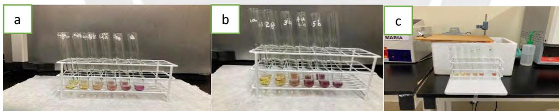
*Nota. Las figuras muestran la reducción del color púrpura intenso característico del radical 2,2-difenil-1-picrilhidracilo (DPPH) ensayos a un color amarillo pálido de los ensayos a) I, b) II y c) III.*
