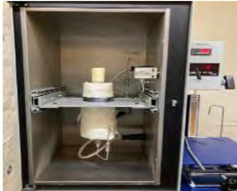
*Nota. La figura muestra la forma correcta de introducir el saco de extracción con muestra de kion liofilizado en el reactor del extractor del equipo de EFS.*
