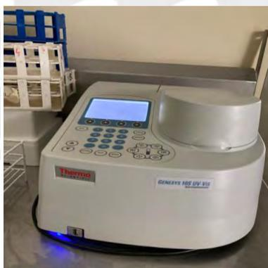
*Nota. La figura muestra el espectrofotómetro Genesys 105 UV-VIS usado en el ensayo de DPPH.*
