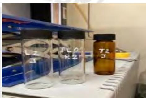
*Nota. La figura muestra los viales que se usan en la extracción por fluidos supercríticos que de izquierda a derecha consta vial de limpieza, vial para jengibre liofilizado y vial color ámbar trampa.*
