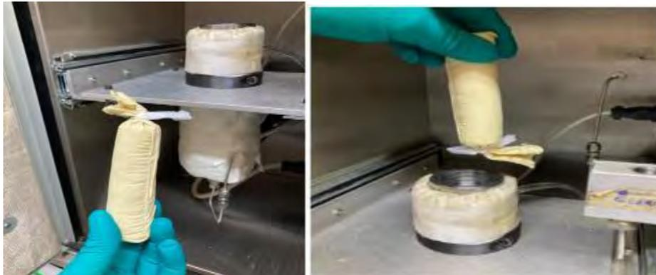
*Nota: La figura muestra saco de extracción con 30 gramos de muestra de jengibre liofilizado debidamente asegurado con un retazo de tela antes de introducirlo en el reactor del extractor de EFS.*
