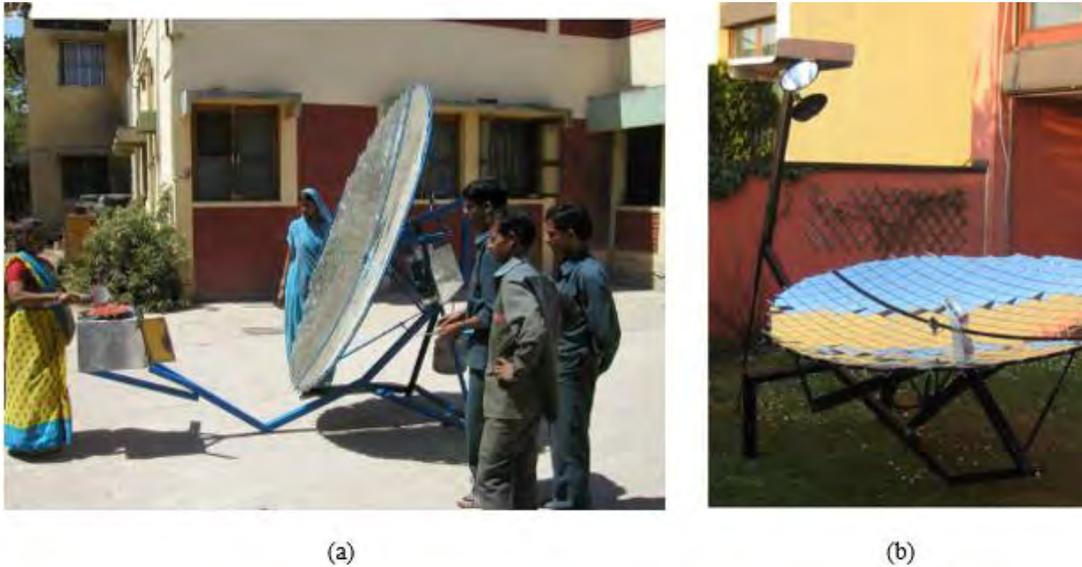
Figura 2.5. Reflector Scheffler 2.7 m<sup>2</sup> de pie y recostado<sup>12</sup>
