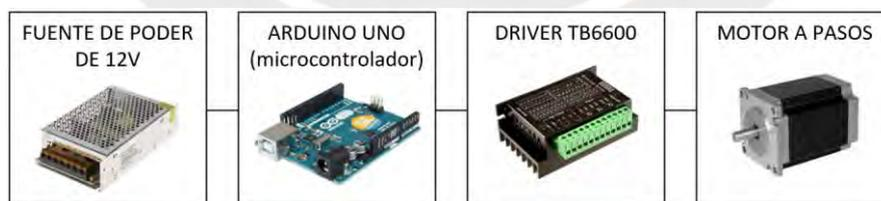
Figura 4.20. Esquema de conexión del motor a pasos
