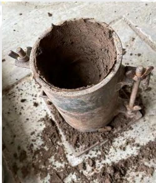
Figura 3.10. Estado de la muestra durante el ensayo Proctor modificado.
