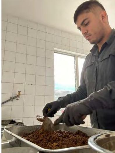
Figura 3.5. Proceso de combinación de suelo y aditivos.
