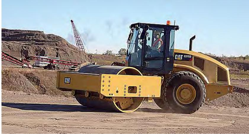
Figura 2.5. Compactación de terreno con rodillo vibratorio (Yepes, 2012).
