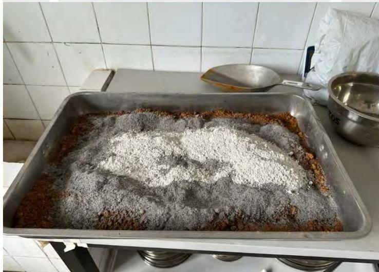
Figura 3.4. Mezcla de suelo, ceniza de cáscara de arroz y cal.
