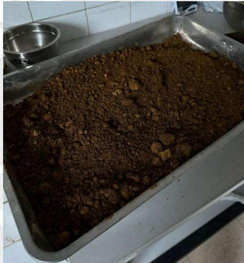
Figura 3.6. Mezcla homogeneizada e hidratada de suelo, ceniza y cal.
