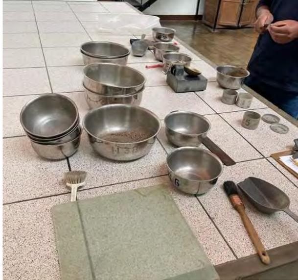
Figura 3.8. Muestra seca extraída para llevar a cabo los ensayos de límites de Atterberg.
