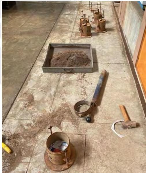
Figura 3.11. Materiales utilizados para ensayos CBR.
