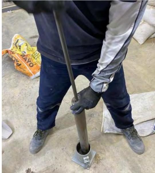
Figura 3.9. Personal técnico realizando compactación de muestra.
