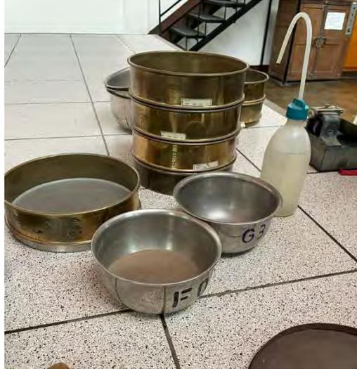
Figura 3.7. Muestra tamizada por la malla #4.
