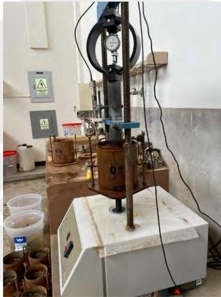
Figura 3.13. Penetración de especímenes CBR.
