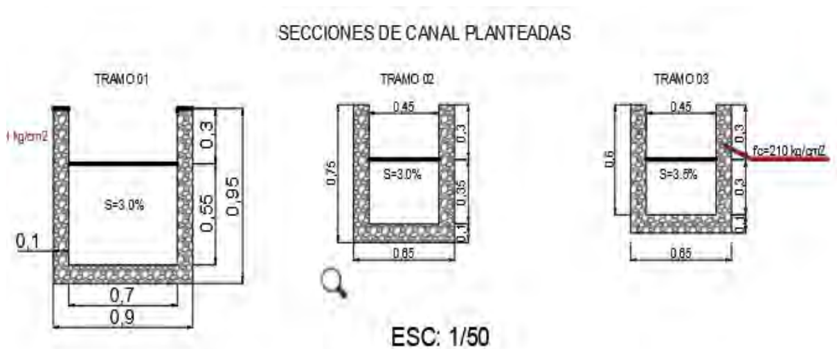
Figura 68. Secciones de canal propuestas.
