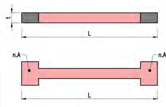
Figura 4: Sección transformada de un muro de albañilería.
