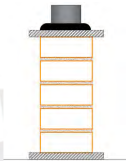
Figura 6: Esquema del ensayo a Compresión axial.
