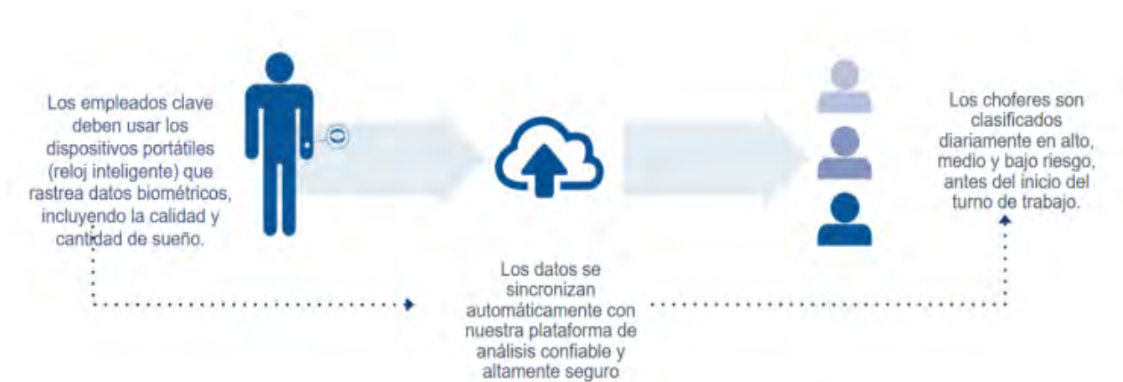
Figura 3. Funcionamiento del sistema de fatiga mediante smartwatch
