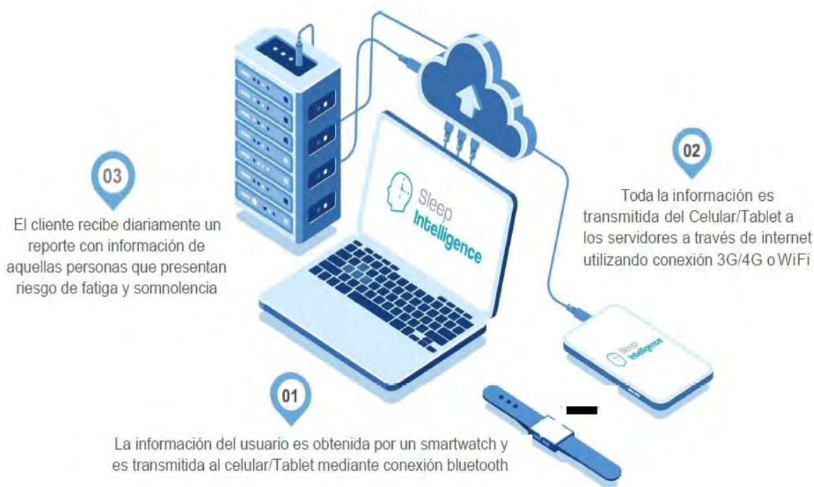
Figura 6. Sistema de control de Fatiga de Sleep Intelligence
