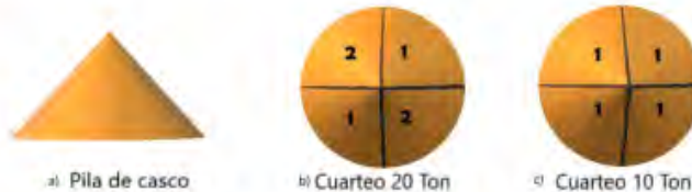
Ilustración 2. Cuarteo de pila de casco
