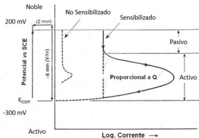
Figura 2.3 - Esquema de las curvas de polarización electroquímica potenciocinética
