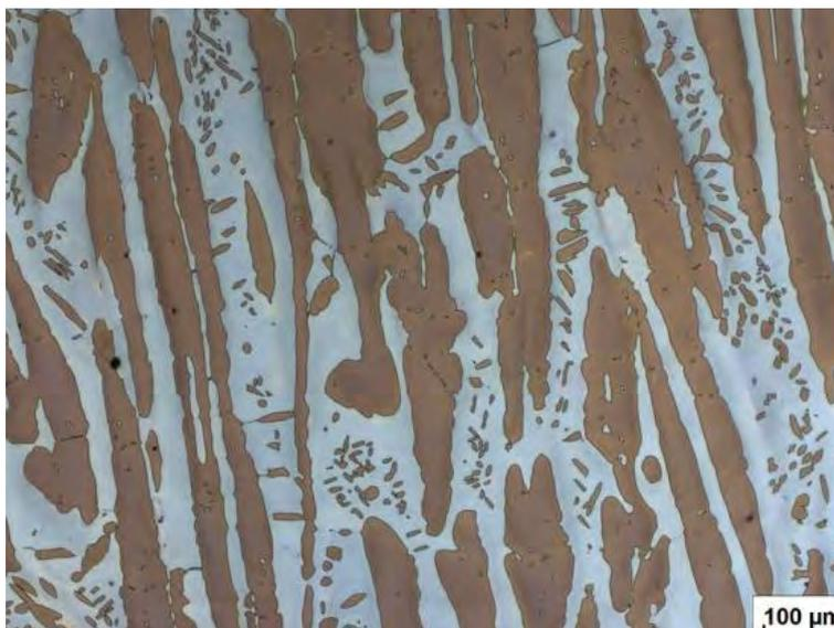
**Figura 1.4 – Microestructura de un acero Dúplex – Reactivo: Ataque electrolítico soda caústica – Tomado de: Struers [3].**
