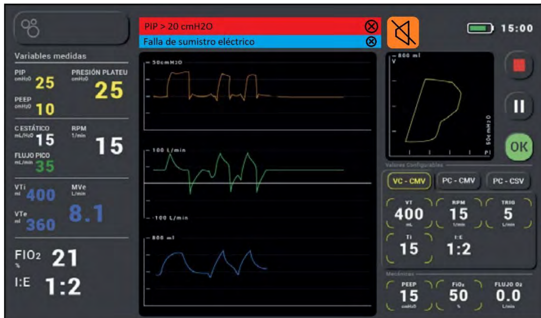
Figura 6.2: Ejemplificación de niveles de alarma con alarmas de Nivel I y Nivel III.
