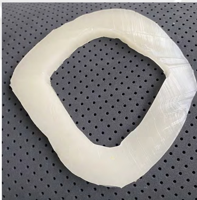
Figura 5.2: Corte del fantoma para obtener la forma del contorno de la máscara facial.
