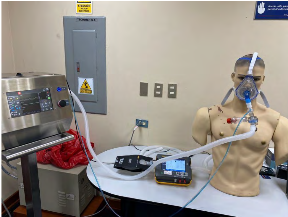
Figura 4.3: Circuito de ventilación ensamblado en laboratorio LABMET usando el accesorio de máscara facial.
