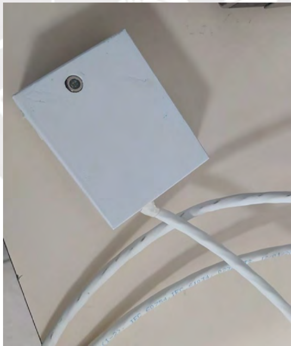
Figura 38: Prototipo unidireccional del sensor de irradiancia
