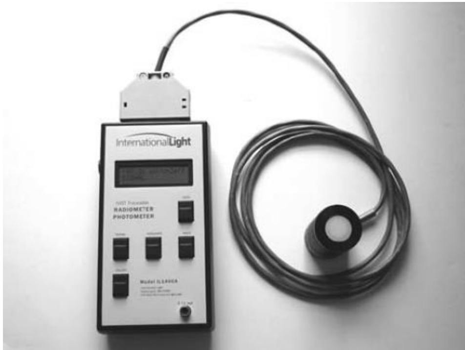
Figura 9: Radiómetro fotónico portable. Fotosensor con filtro UV a la derecha [18]
