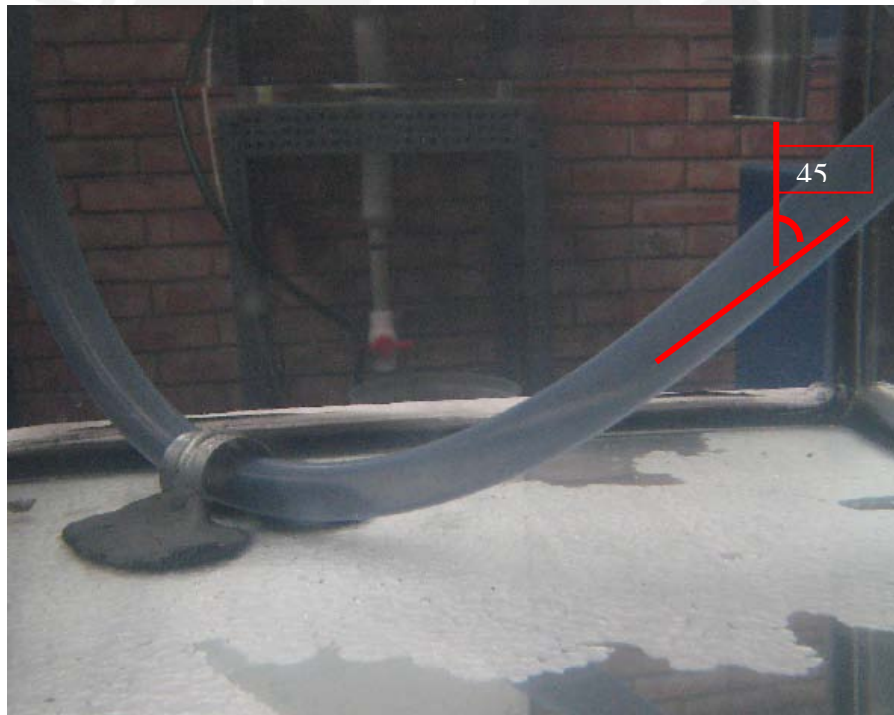
Figura 45. Experimento, se forma un ángulo de 45 grados entre el haz ultrasónico y la manguera.
