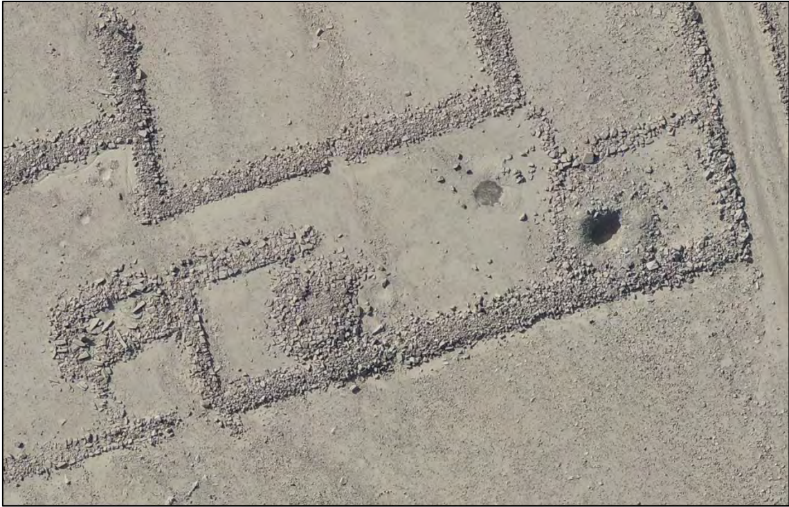
FIGURA 136, Ortofoto parcial del geoglifo RSCO-G112 donde se aprecia la diferencia de superficies propia de la construcción de geoglifos con técnica negativa.
