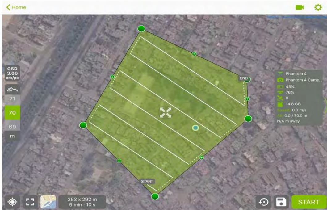
FIGURA 6. Configuración de plan de vuelo con el programa Pix 4D Capture.
