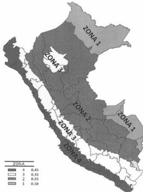
Figura 12 – Zonas sísmicas (Figura N°1, E.030-2019)
