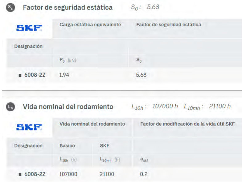
Figura D4. Resultados del cálculo para el rodamiento 6008-2Z del eje principal.
