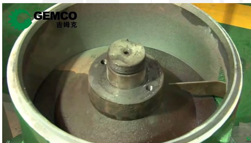
Figura 42. Disco de lanzar cosas dentro de la carcasa del eje principal.
