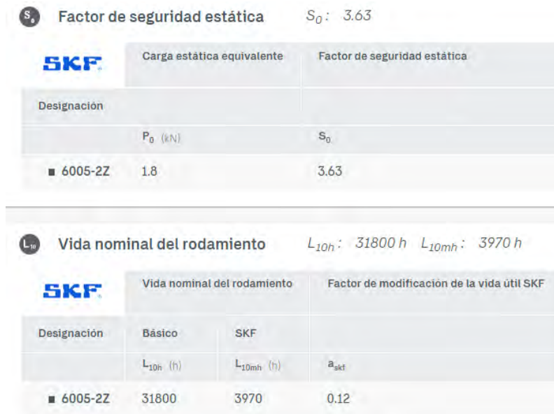
Figura G2. Resultados del cálculo de rodamientos del eje de rodillos.
