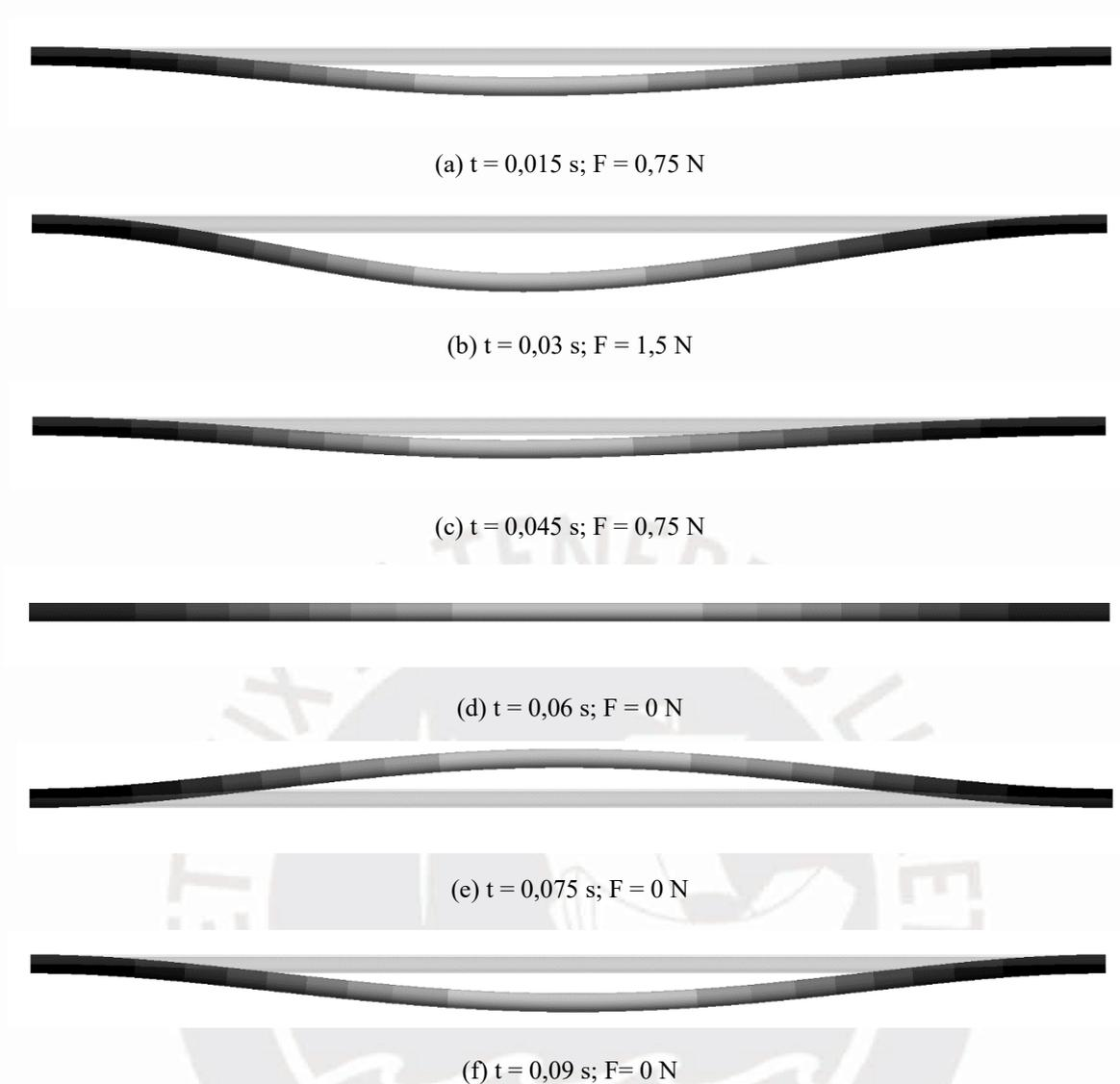
Figura 3.10: Respuesta vibratoria inicial de la tubería debido a la carga instantánea inicial.
