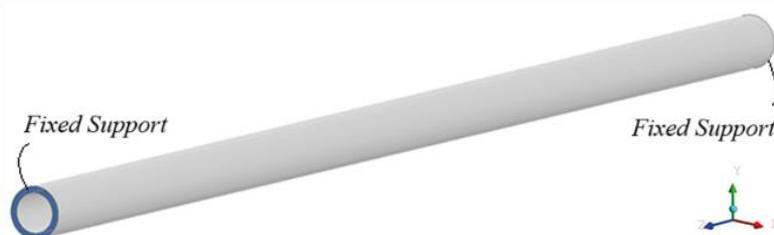
Figura 3.1: Modelo tridimensional de la tubería.
