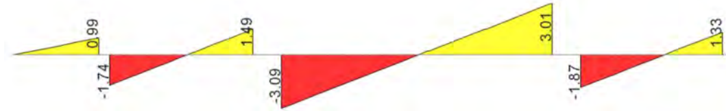
Figura 7.5. Diagrama de fuerza cortante por carga viva
