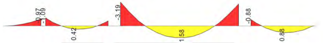
Figura 7.3. Diagrama de momento flector por carga viva
