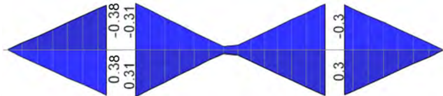
Figura 7.6. Envolvente de DMF por sismo en X (ton-m)
