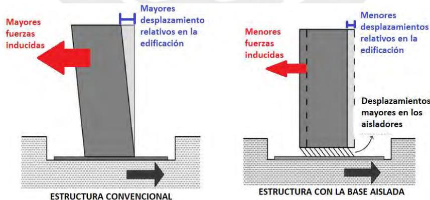
Figura 10. Comparación de fuerzas y desplazamientos inducidos por el sismo en edificación con base fija y base aislada.
