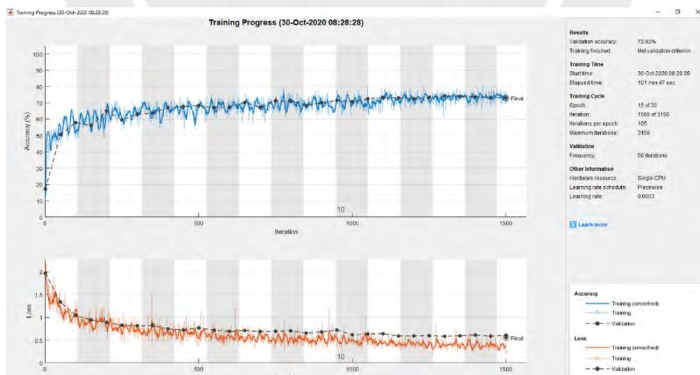
Figura 4.1. Gráfica del proceso de entrenamiento con 800 imágenes basada en la arquitectura Resnet18 con Minibatchsize de 8 y Epocas de 15. Fuente: Propia.
