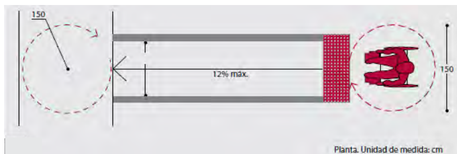
Figura 3. Rampa simple. Fuente: Manual de Accesibilidad Universal (2010)
