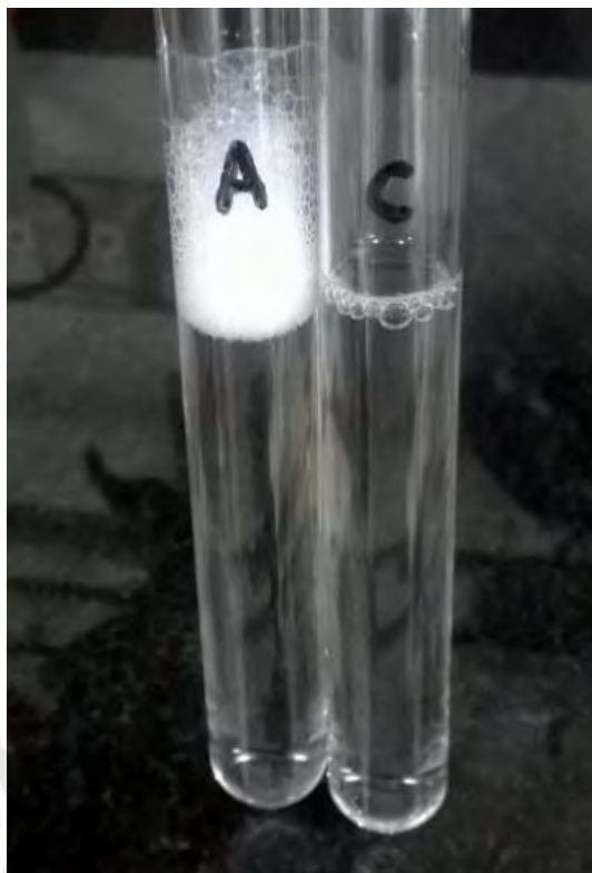
Figura 40. Prueba de espuma realizada a las muestras de NPEO antes (A) y después de 180 minutos de reacción (C) a 15mA con FG modificado.
