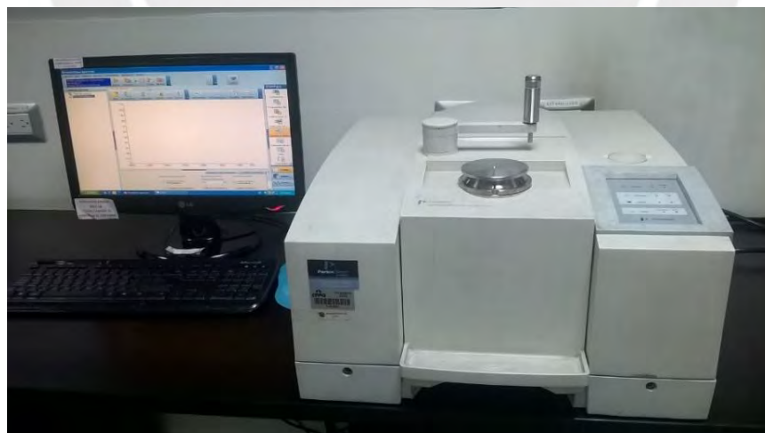
Figura 18. Espectrofotómetro infrarrojo marca Perkin Elmer modelo FT-IR Spectrum One.
