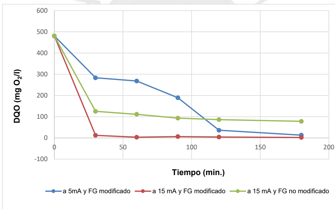
Figura 45. Variación de DQO al trabajar con FG modificado con intensidades de corriente de 5mA y 15mA comparado con proceso utilizando FG no modificado a 15mA
