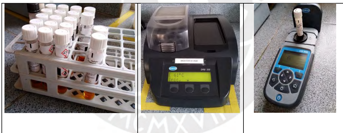
Figura 21. Fotografías del kit para la determinación de DQO de la marca HACH, tubos con reactivo (Izquierda), reactor para digestión de muestras (Centro) y espectrofotómetro (Derecha).
