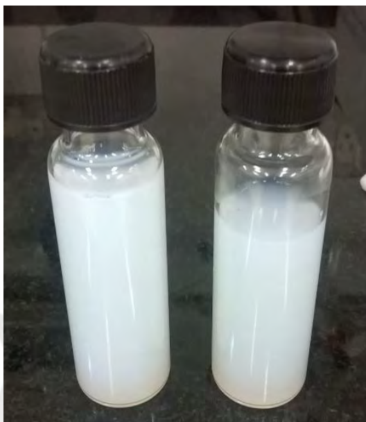
Figura 49. Apariencia de la muestra de agua industrial antes de ser tratada (izquierda) y después de ser tratada (derecha).
