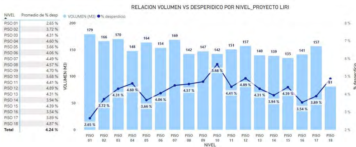
Figura 39. Histograma de volumen de concreto por piso y promedio de desperdicio – Proyecto Liri
