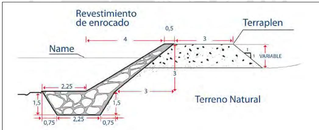
**Figura 9.** Sección transversal de un dique de enrocado.
