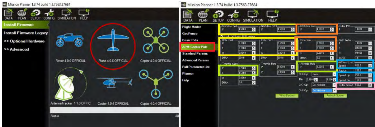
Figura 4.24: Selección del tipo de vehículo aéreo en Mission Planner (izquierda), configuración de ganancias PID en Mission Planner (derecha) (Fuente: Elaboración Propia)
