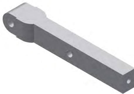
Figura 4.12: Articulación de ala en ABS empleadas la estructura de las alas con el mecanismo de vuelo. (Fuente: Elaboración propia)
