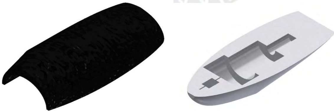
Figura 4.13: Fuselaje superior e inferior en espuma de polipropileno expandido (EPP) (Fuente: Elaboración propia)
