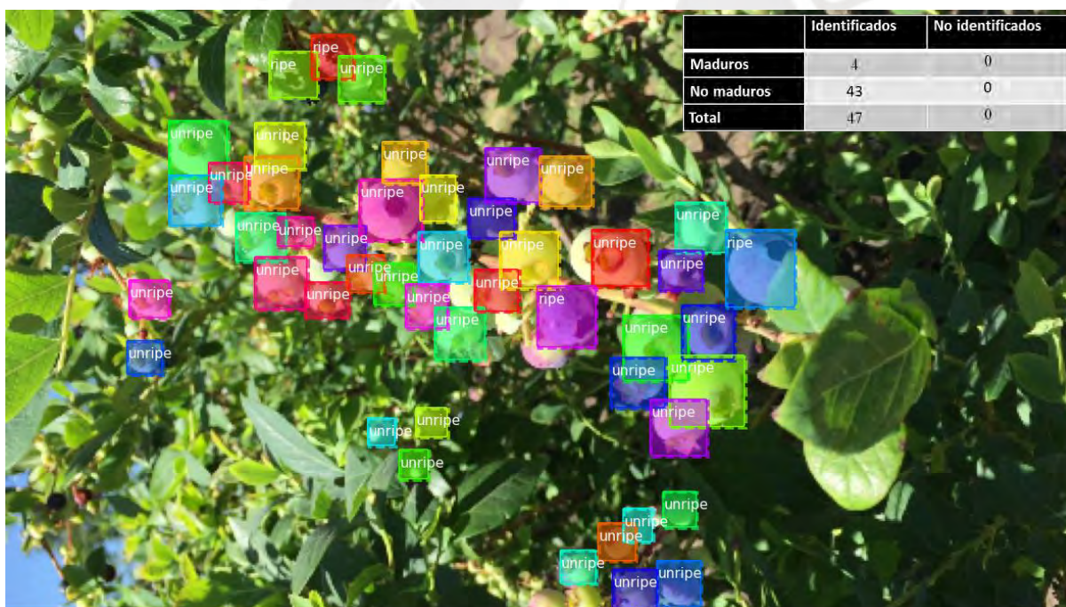
Figura A5: Imagen prototipo obtenida por el robot aéreo (arriba) e imagen procesada (abajo), en la cual algunos arándanos identificados son erróneamente clasificados, se clasifica arándanos no maduros como maduros.
