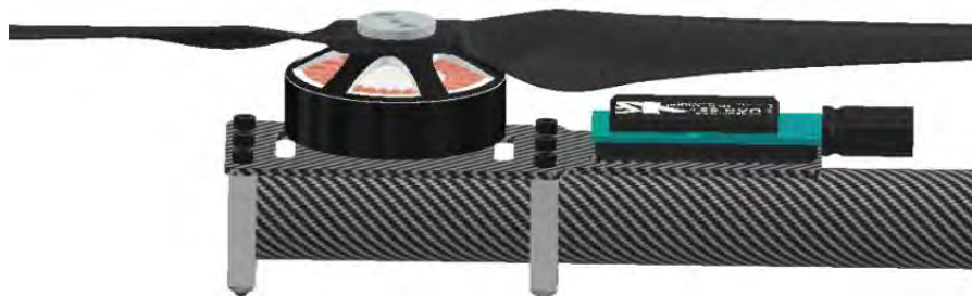
Figura 4.8: Disposición final del motor y ESC. Fuente: Elaboración propia.
