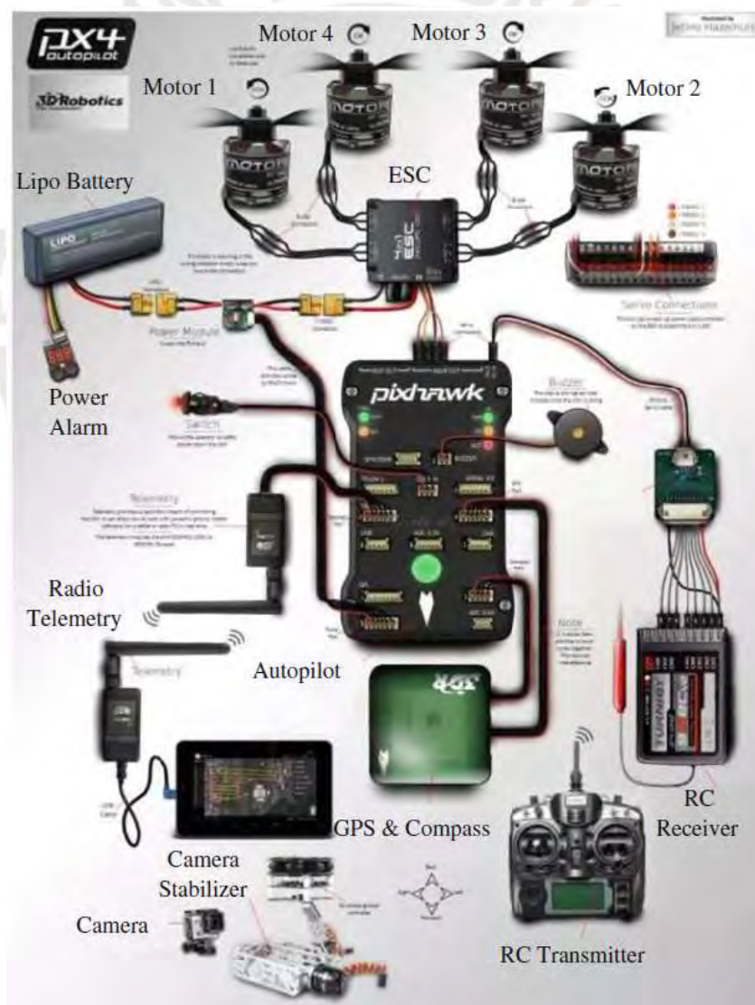
Figura C.5: Distribución de componentes entrelazados con controlador PixHawk. Extraído de Quan, 2017.
