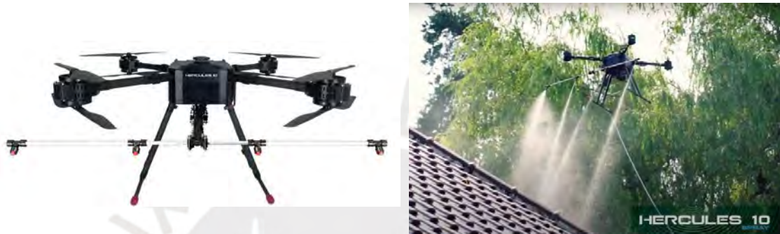
Figura 2.2: Operación de Hercules 10 v1.7 TETHERED SPRAY . Adaptado de Drone Volt, 2021.
