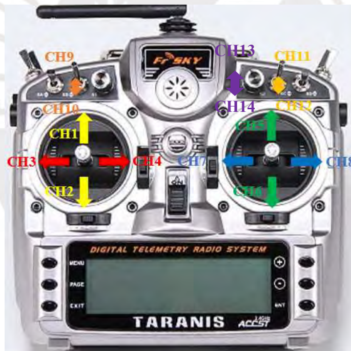
Figura 4.26: Canales a emplear para el radio controlador. Fuente: Elaboración propia.
