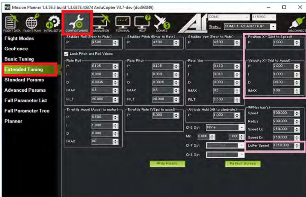
Figura 4.41: Configuración de parámetros Loiter en Mission Planner. Extraído de ArduPilot, 2023.
