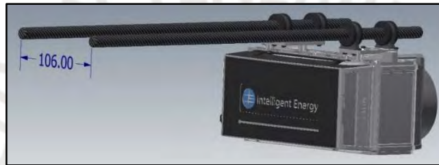
Figura 4.13: Sujeción de pila mediante riel de tubos . Fuente: Elaboración propia.
