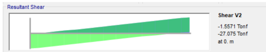
Imagen 104. Fuerzas cortantes para viga
