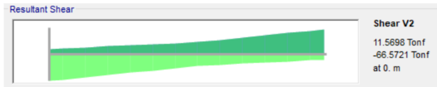
Imagen 128. Fuerzas cortantes para viga
