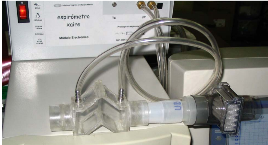
Figura 6-8: Sensor GISS y el filtro Pall Pro-Tec.
