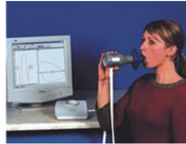
Figura 3-2: Espirómetro de flujo para PC, Spirotrac 6800 de Vitalograph.
