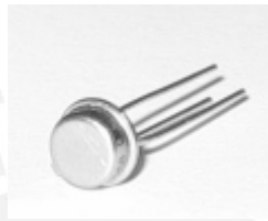
Figura 4-6: Sensor de temperatura LM35A, empaque TO-46 (las hojas de datos están en el CD adjuntado a la tesis).
