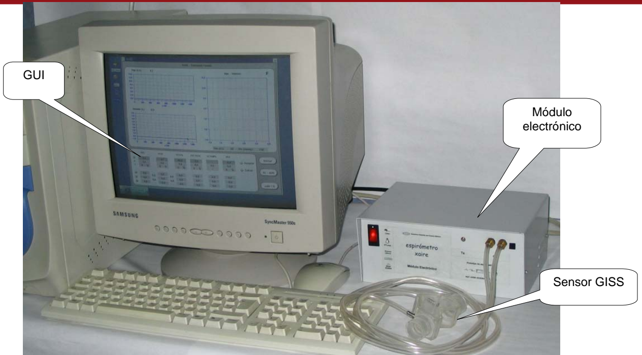
Figura 5-5: Prototipo de espirómetro XAIRE desarrollado en este trabajo de tesis.
