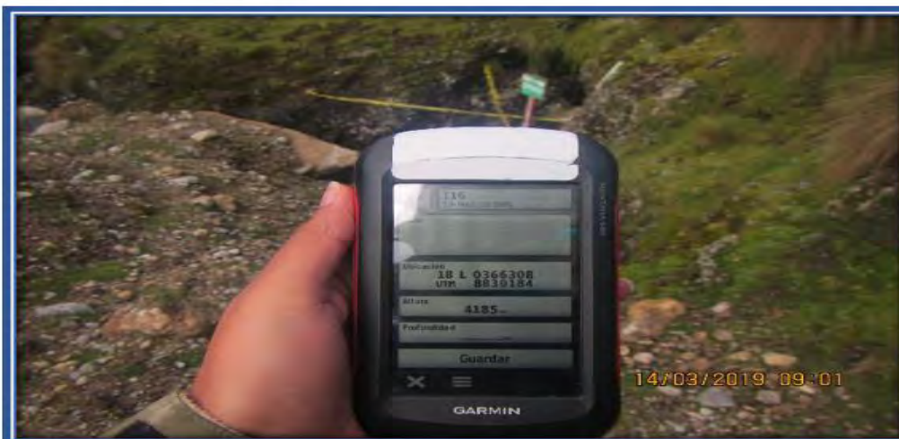
Fotografía N° 4: Lectura de las coordenadas tomadas en la Bocamina Lalaquia 2, UTM (Datum WGS 84-18L): E 366 308, N 830 184)
