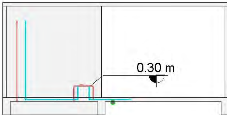
Figura 61: Elevación de tubería en baños antes de modificación
