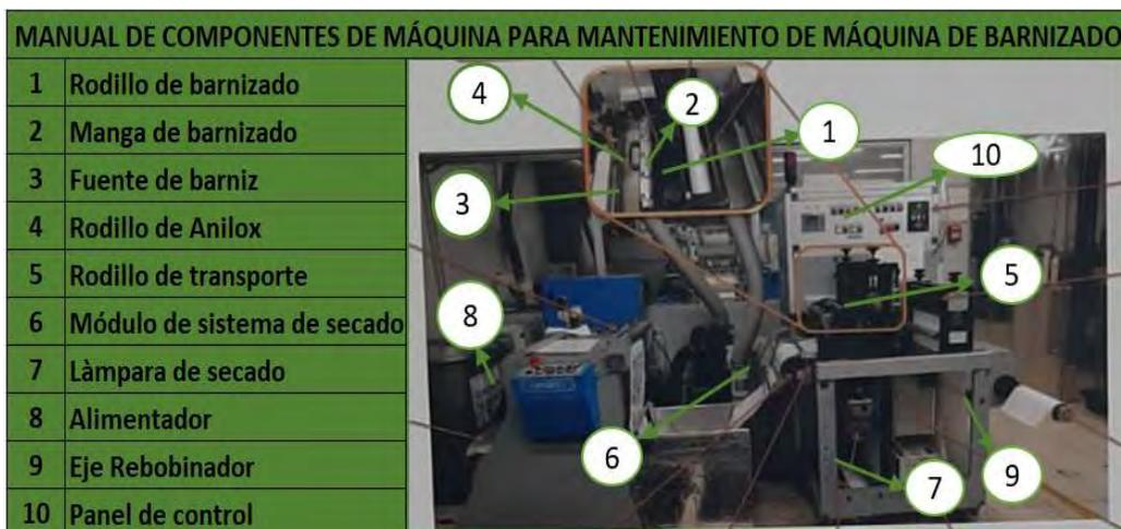
Figura 39: Manual de componentes de máquina de barnizado
