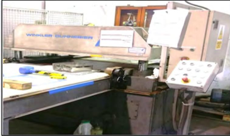
Figura 17: Máquina troqueladora de sobres
