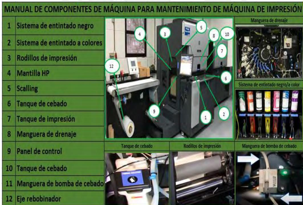
Figura 38: Manual de componentes de máquina de impresión
