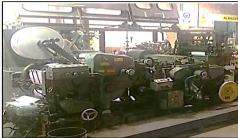
Figura 18: Máquina armadora de sobres
