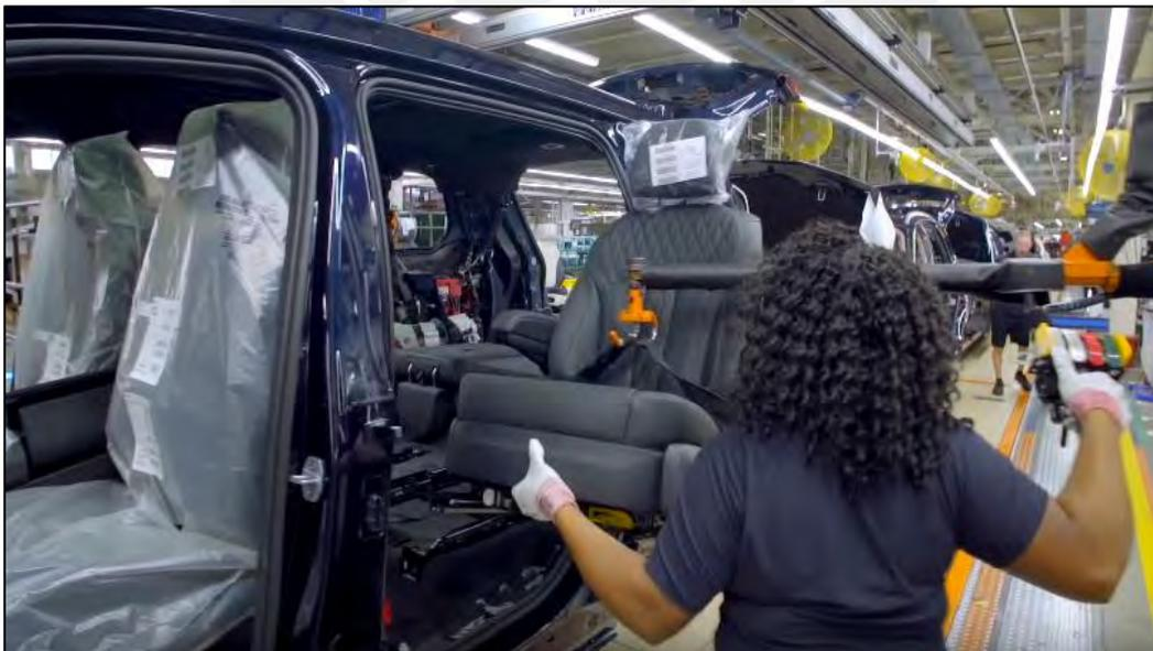
*Ilustración 33: Instalación de la mueblería por parte de los operarios
