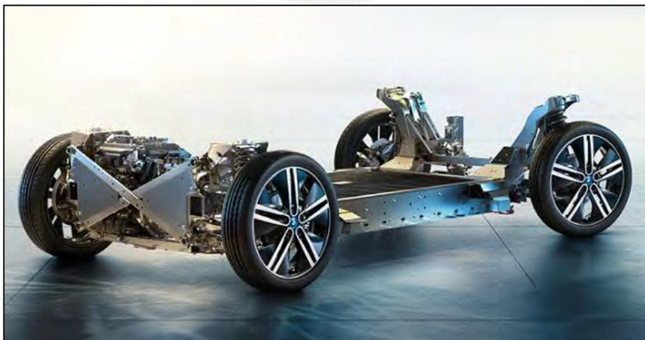
Ilustración 29: "Drive train" listo para ser acoplado a la carrocería
