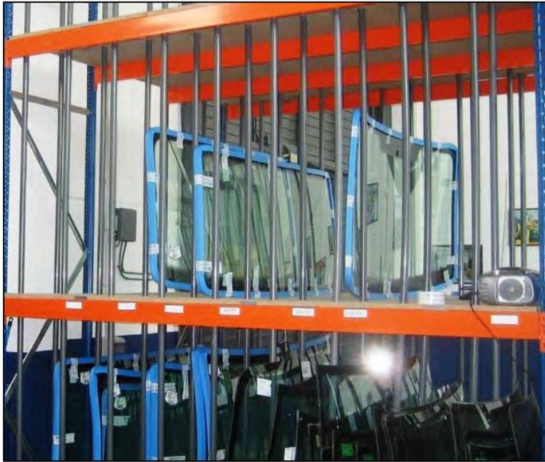
*Ilustración 51: Estantería metálica para lunas de coche y parabrisas
