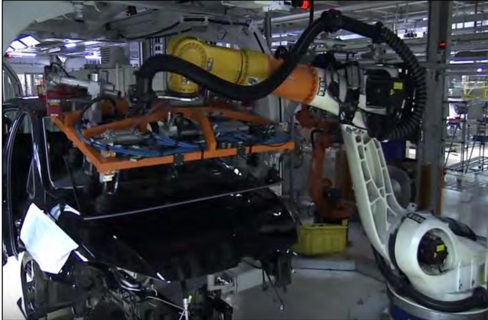
*Ilustración 32: Ejemplo de instalación automatizada de parabrisas
