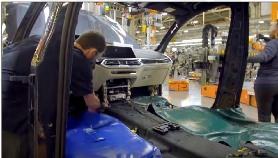
*Ilustración 31: Instalación del tablero y sistemas eléctricos
