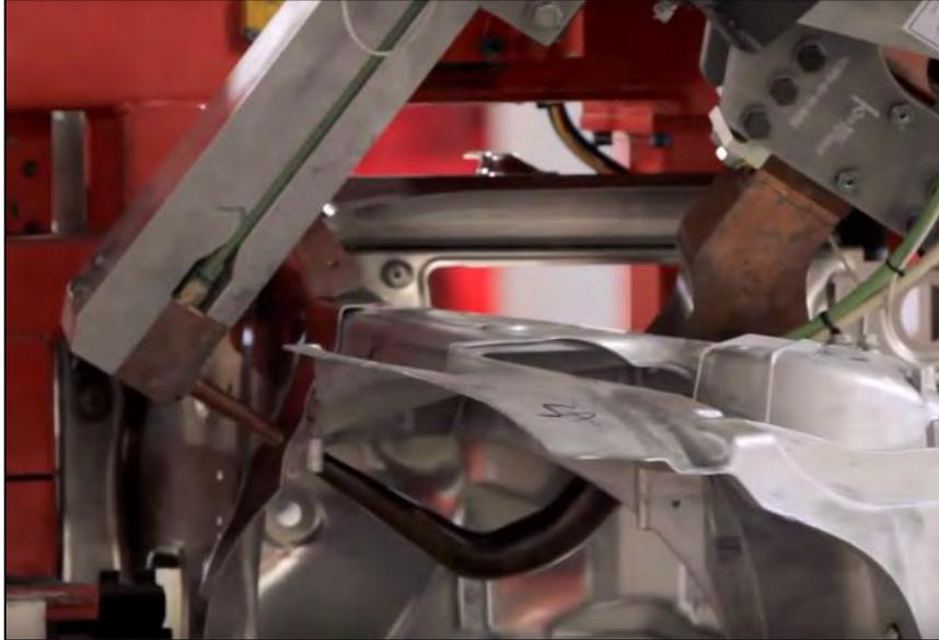
Ilustración 24: Electrosoldadura por puntos de la carrocería
