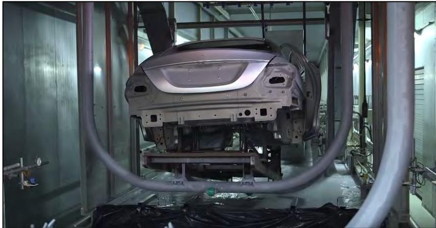
*Ilustración 26: Inmersión de la carrocería en pintura electroforética
