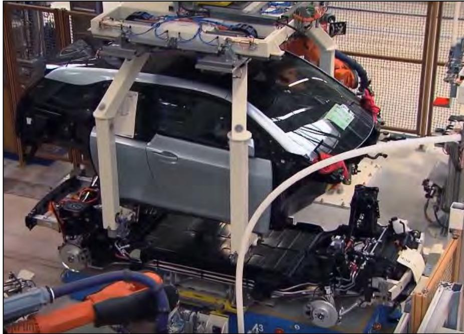
*Ilustración 30: Acoplamiento entre el tren motriz y la carrocería
