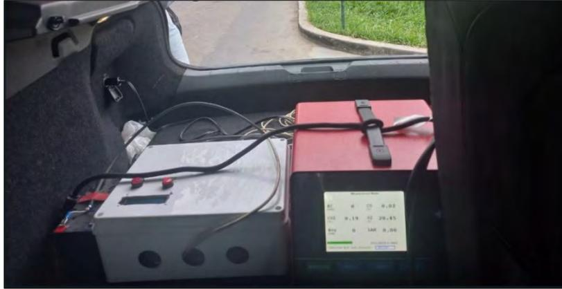
Figura 2.7 - Instrumentación para mediciones a bordo de los factores contaminantes y datos del vehículo.
