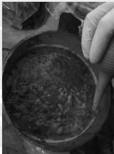
Figura 14. Extracción del agua de exudación mediante el uso de una pipeta Elaboración propia
