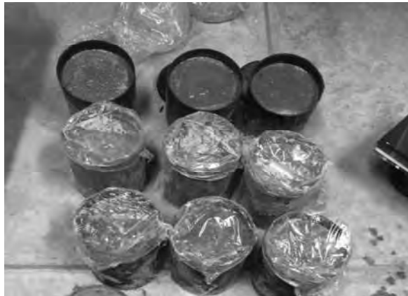
Figura 13. Probetas cubiertas con papel film para evitar la evaporación Elaboración propia
