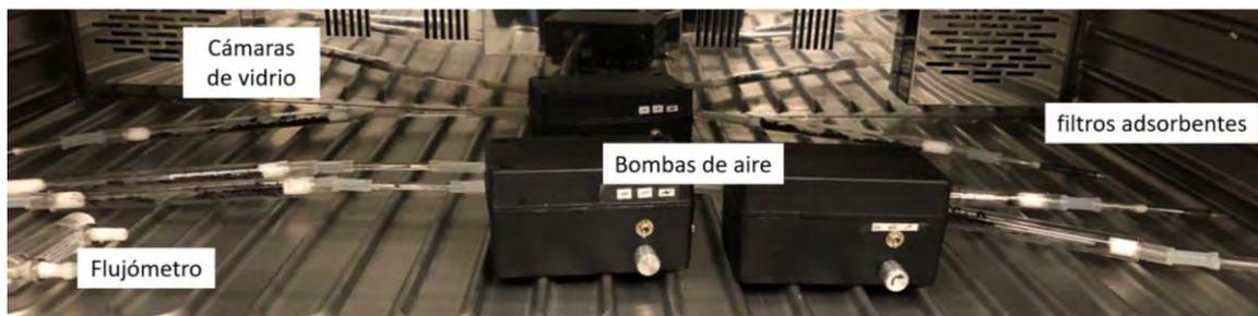
Figura 5. Sistema armado para la colecta de volátiles.
