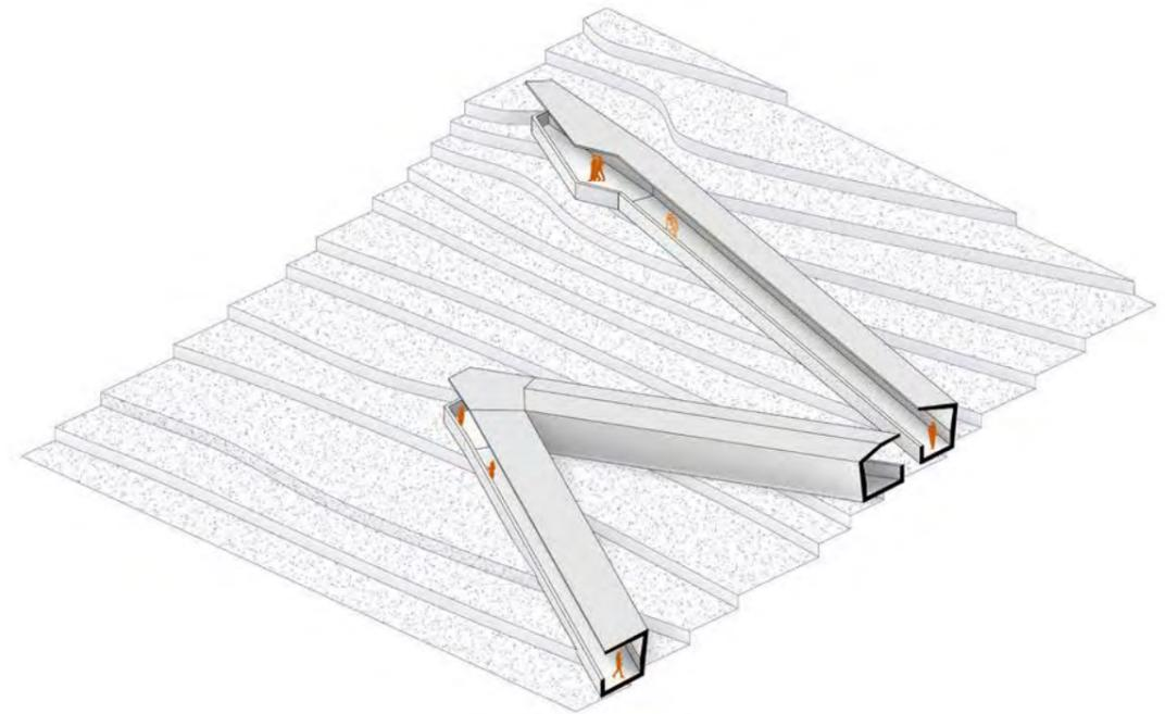
El mirador se erige como una pieza autónoma que se conecta por el recorrido, usa una serie de placas verticales que van abriendo la visual hacia el exterior y que protegen del lado de la carretera Panamericana. Las rampas se van acomodando a la topografía y llegan a una altura de 10 metros para tener visual hacia el valle de El Ingenio.
