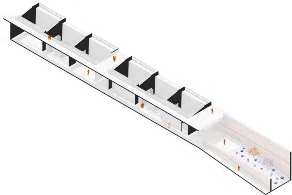
El techo en concreto visto se inclina generando una doble teatina vertical que permite iluminar el área interior y que aparenta flotar sobre la arena desde el exterior. Este mismo techo se repite en 4 módulos donde 2 de ellos conforman la biblioteca con un patio en el medio y los otros 2 módulos contienen 2 talleres separados por un patio.
