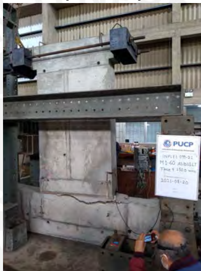
Figura 3.15: Evolución del patrón de fisuras en la rama negativa [-]
