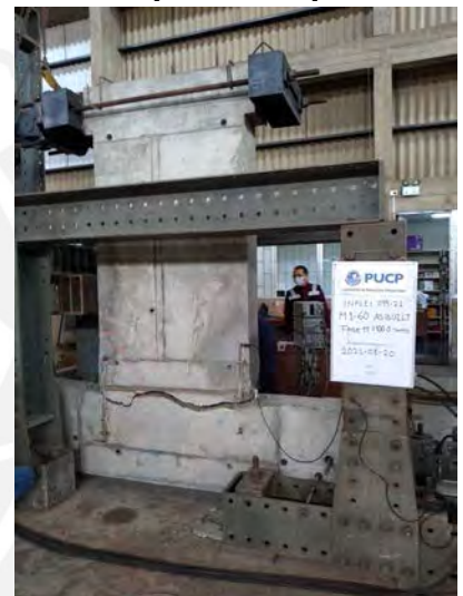
Figura 3.15: Evolución del patrón de fisuras en la rama negativa [-]
