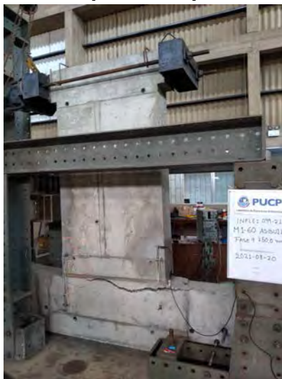
Figura 3.15: Evolución del patrón de fisuras en la rama negativa [-]
