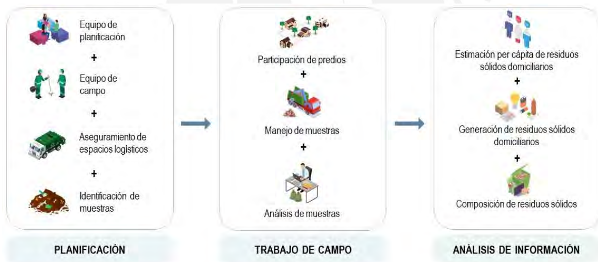
Figura 2 - Esquemática del proceso de caracterización de residuos sólidos municipales, con énfasis en la estimación de la generación per cápita propuesto por el MINAM (2019a).
