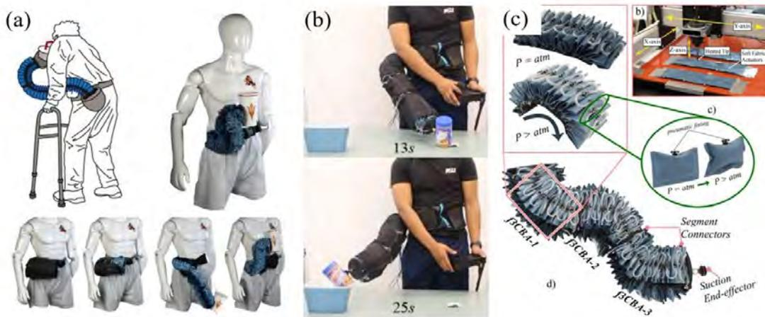
Figura 2.11. (a) Prototipo de fSPL. (b) Pruebas fSPL mediante joystick. (c) Actuadores blandos de tela. (Fuente: Nguyen et al., 2019)
