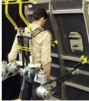
Figura 2.8. Prototipo de SRL usado en la tarea de taladrado.
