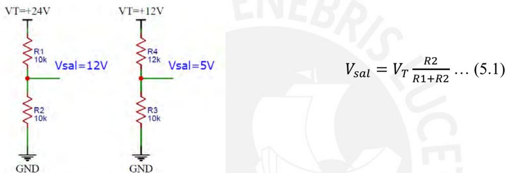
Figura 5.3. Diagramas de los divisores de voltaje.
