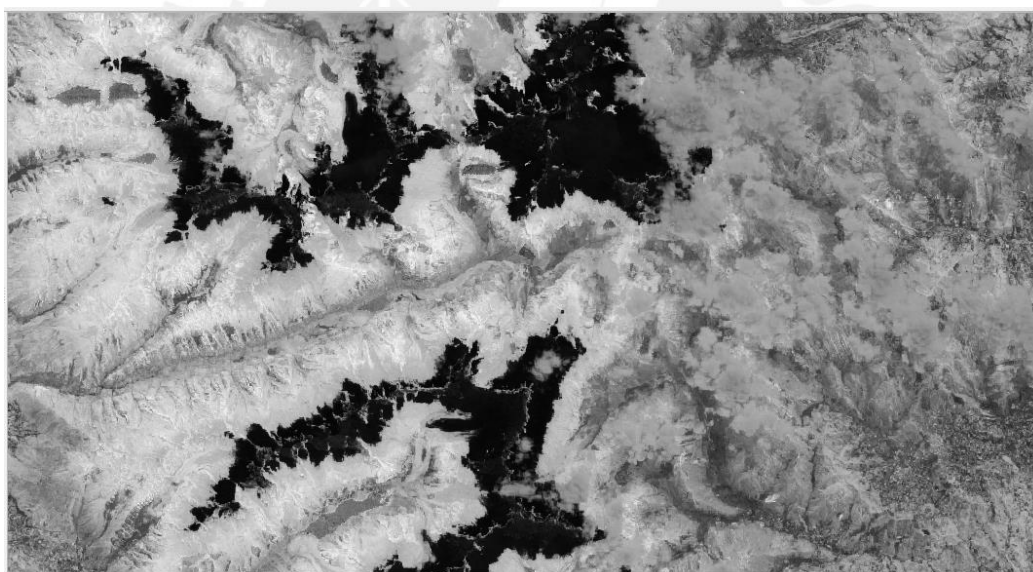
Figura 4.8. Cálculo NBR para verificar área quemada de la figura 4.7. Fuente: Elaboración propia
