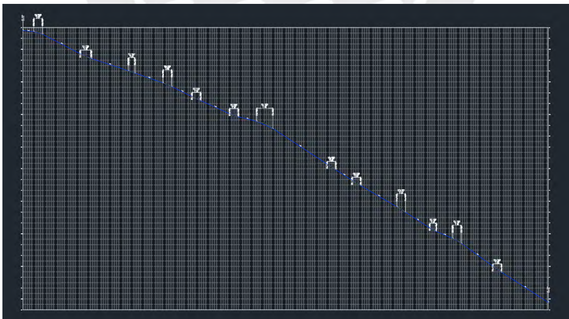
Figura 4-11. Perfil que representa la rasante directamente. Elaboración propia
