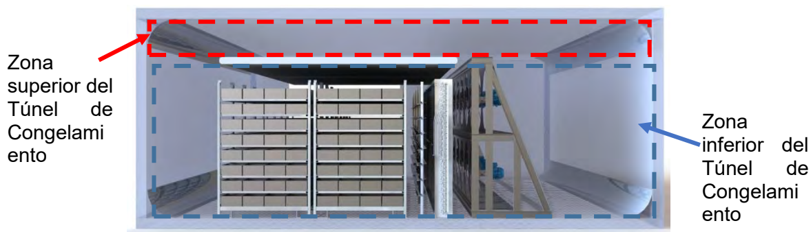
Figura 2.29. Zona superior e inferior del túnel de congelamiento
