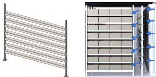
Figura 2.25. a) Vista isométrica y (b) Trayectoria idealizada del aire Fuente: Propia
