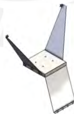
Figura 2.27. Base soporte de ventiladores
