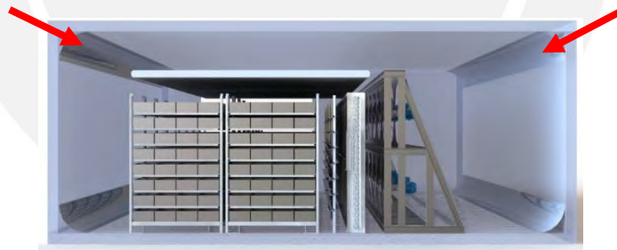
Figura 2.28. Distribución de deflectores laterales en túne de congelamiento
