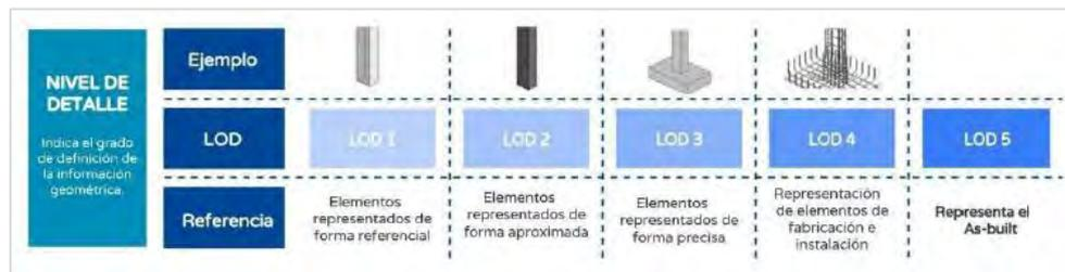
**FIGURA 2.4 Ejemplo de nivel de detalle LOD**
