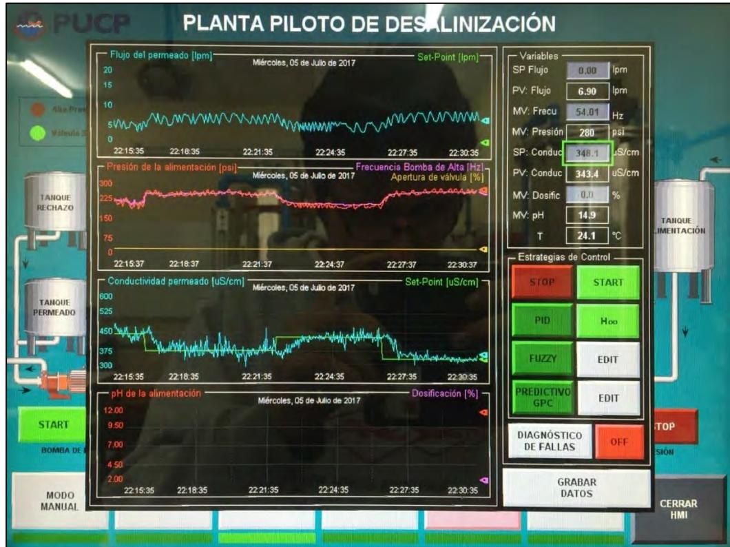
**Figura 5.20:** Interfaz Hombre-Maquina para la supervisión y control en tiempo real del sistema de control  $H_{\infty}$  de la planta desalinizadora de la Pontificia Universidad Católica del Perú (PUCP)
