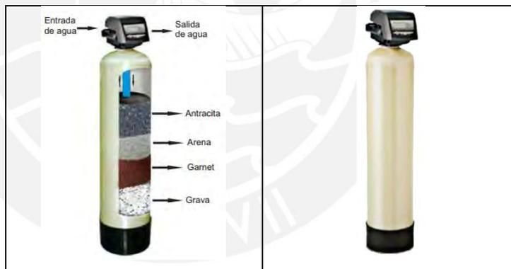
**Figura 3.5.** Filtro Multimedia (Izquierda) y Carbón Activado (Derecha)
